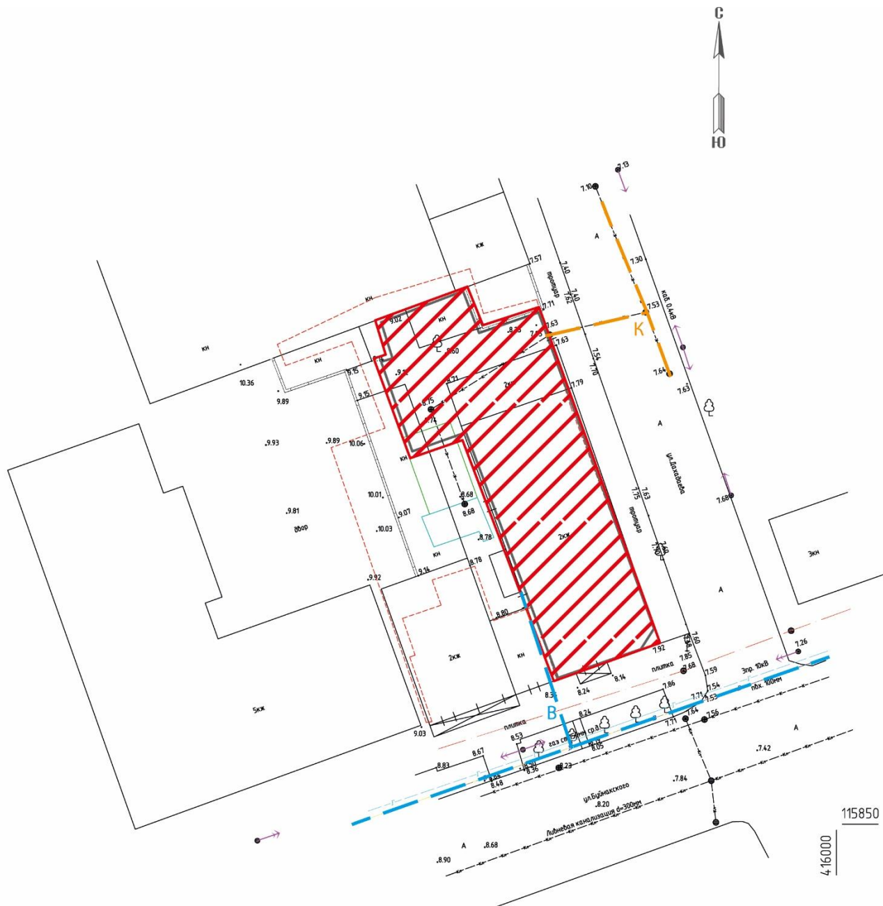
Контур перемещения земляных масс вместе с подземными инженерными сетями в границах участка проектирования
